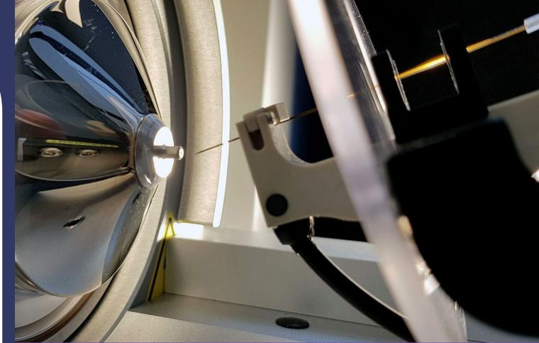
Aiguille d'ionisation nanoESI nébulisant la sortie de chromatographie vers l'entrée du spectromètre.
